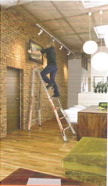
成直角梯，貼近作業牆面
