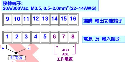
接線時, 請務必確認電源電壓是否正確並接入正確端子編號。為設備及儀表安全, 建議在儀表前安裝保險絲(Fuse) 或 斷路器(Breaker)。
