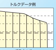
\*VFS15-4015PLで、東芝標準三相400V-1.5kW 4極モータをパラメータ設定のうえ駆動した場合。
