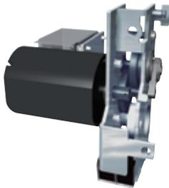
投入彈簧由馬達儲能，當斷路器投入時，彈簧則自動儲能。(ON儲能方式)，以投入線圈(CC)來遙控投入，而跳脫線圈(SHT)來遙控開路。
