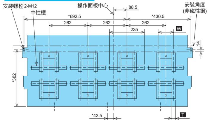
固定型 AE630-SW, AE1000-SW, AE1250-SW, AE1600-SW
