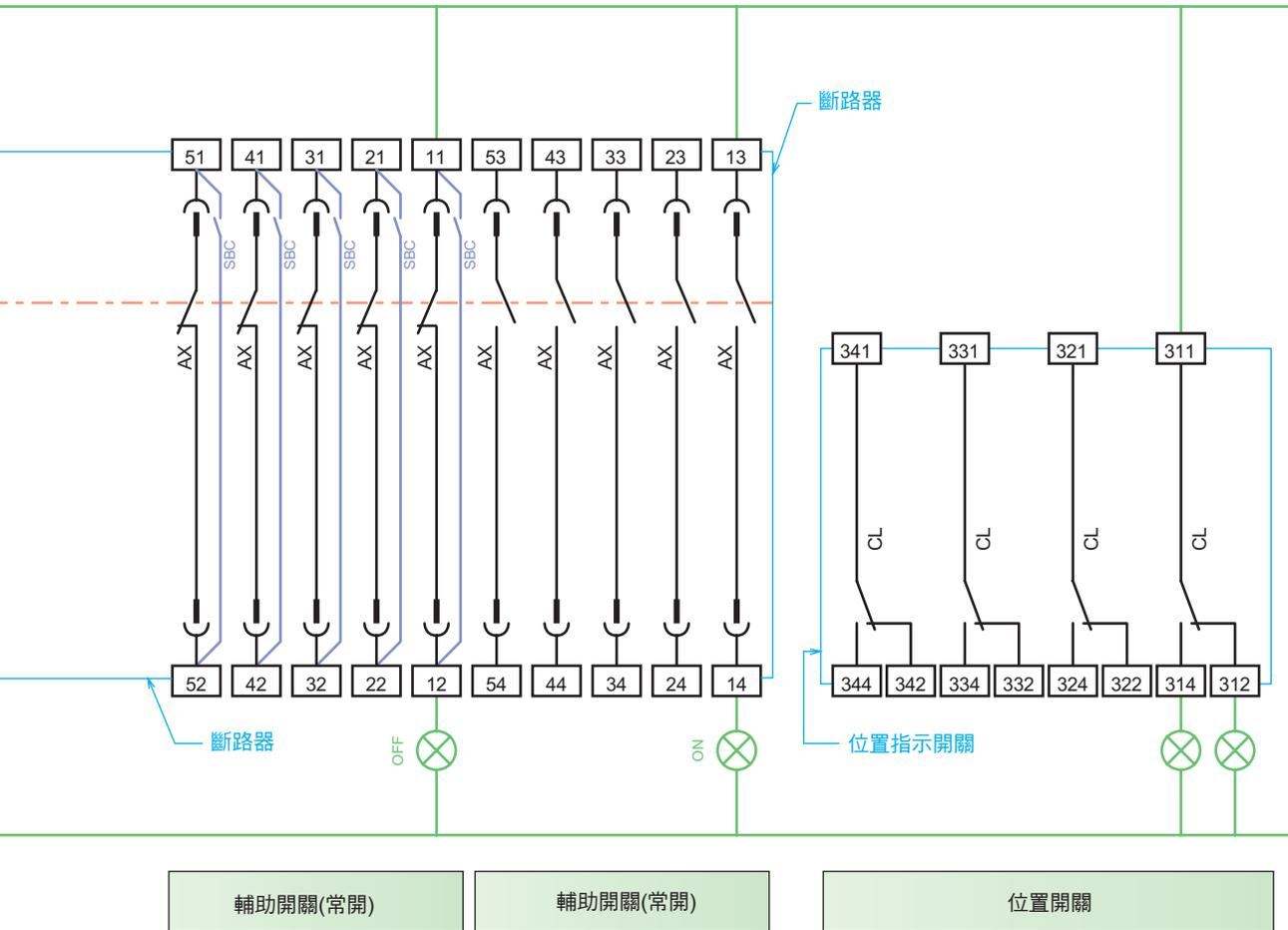
圖1 UVT控制施加電壓
