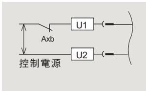
也可使用OFF儲能方式，當斷路器跳脫時，投入彈簧則自動儲能，這只能適用於將輔助開關的B接點(AXB)串接於電動儲能電路。使用DC(直流)電源時，請使用大容量輔助開關(HAX)。
