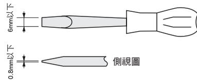
2.將一字起子插入ETR蓋的開口，然後按照左圖所示輕輕向上推，即可將護蓋打開。
