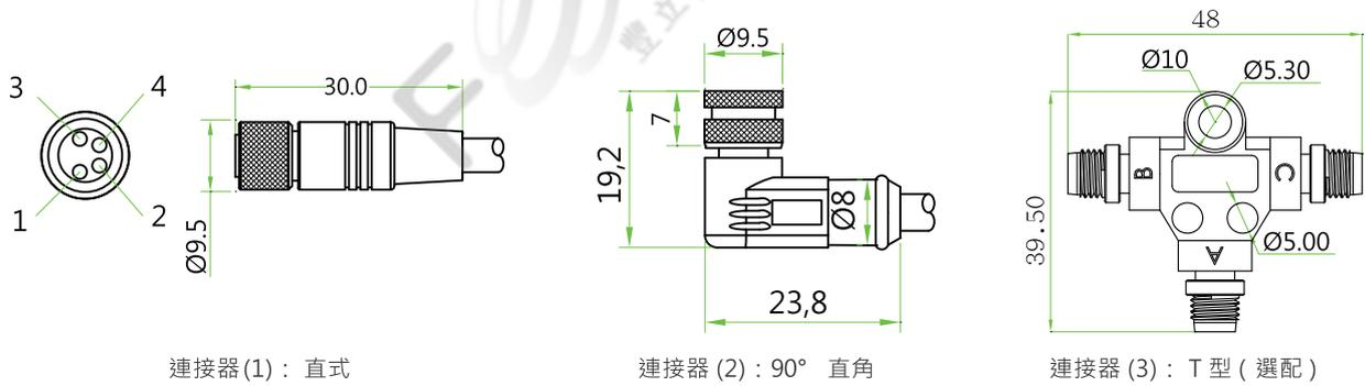
搭配M8細牙電纜之連接器；導線標準長度：3m 導線選擇長度：5m；10m TX：五蕊；RX：五蕊
