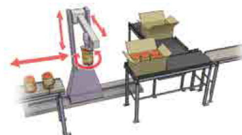
[使用內置定位的裝箱裝置示例]
