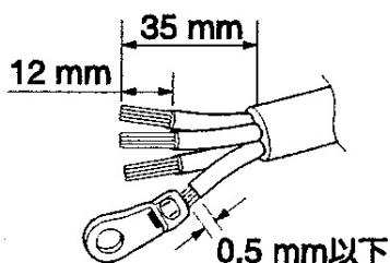
※圧着端子のかしめは  $\begin{cases} 8 \text{ mm}^2 \text{ は } 980 \text{ N} \\ 14 \text{ mm}^2 \text{ は } 1,400 \text{ N} \end{cases}$  1分間の張力に耐えること。
