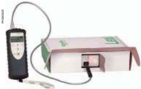
使用多功能下载器，无须打开包装即可下载参数。
