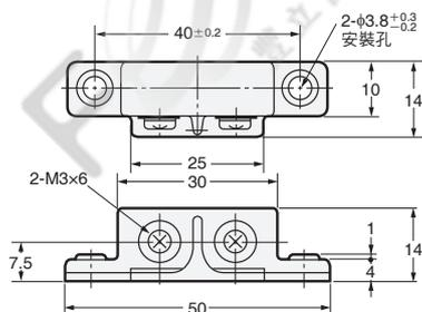
註：端子台部的M3螺絲的鎖緊扭力請設為0.59N·m以下。
