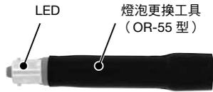
2) 將 LED 燈頭底部的安裝扣腳與元件內的燈座凹槽對齊後插入，輕按的同時按順時針方向轉動，即可安裝。
