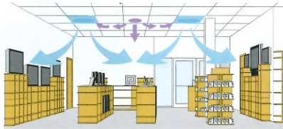
■ 空調出風口 ■ 輕鋼架節能循環扇
