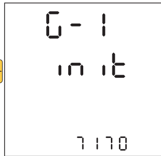
初始化 輸入7170後會重新開機並回復 原廠設定值，但校正值保留
